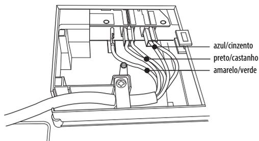
1. Retire a tampa do terminal (A) desapertando o parafuso e insira a tampa na dobradiça (B) do terminal.
