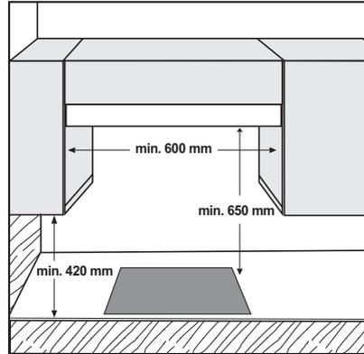
**NOTA:** se a distância "A" entre a parede dos armários for entre 600 mm e 730 mm, a altura "B" terá de ser, no mínimo, de 530 mm. Se a distância "A" entre a parede dos armários for maior do que a largura da placa, a altura "B" terá de ser, no mínimo, de 400 mm. Em caso de instalação de um exaustor por cima da placa, consulte as instruções do exaustor para uma distância correcta.
